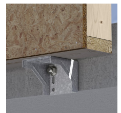
Holzkonstruktion auf dem Konsolwinkel an der Deckenschmalseite.
