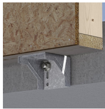
Holzkonstruktion auf dem Konsolwinkel an der Deckenschmalseite.
