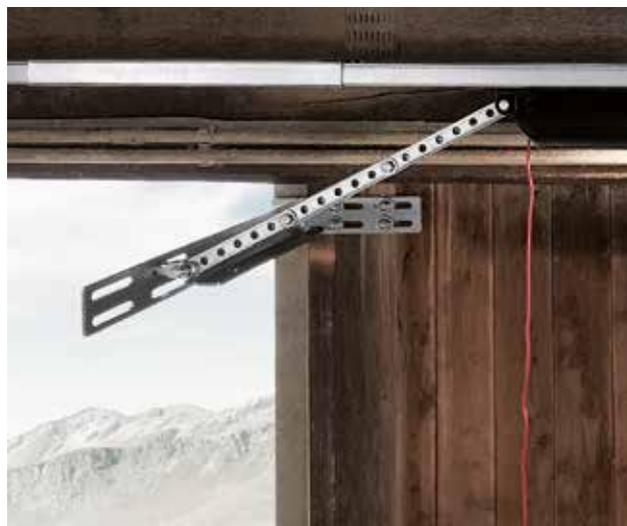
**Einbau innen horizontal. Zwei Schubstangen stabil miteinander verbunden, um eine Höhendifferenz auszugleichen.**
