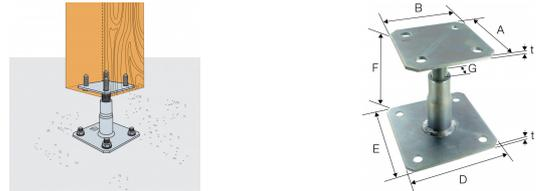
Befestigung APB100/150Z an Beton
